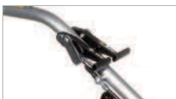
Diferencial e inversor con palanca de mando en el manillar.
