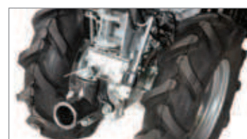
Conexión rápida QuickFit que permite cambiar los aperos sin herramientas.
